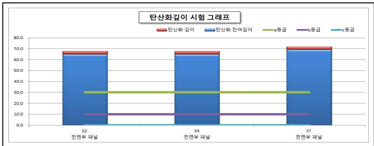
【그림 77.9】 탄산화 깊이 측정결과
