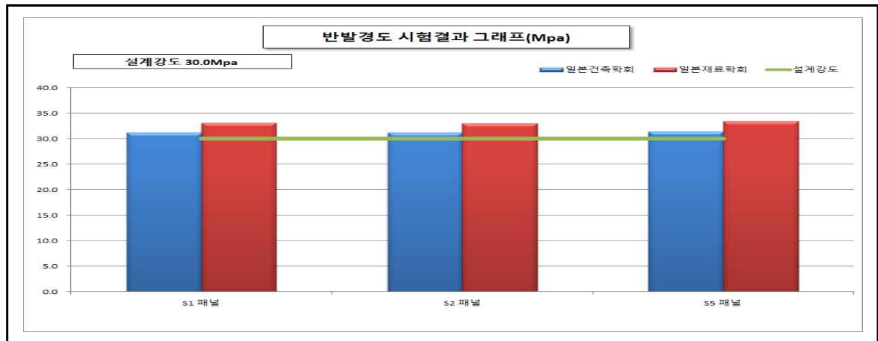
【그림 77.8】 반발경도시험 측정결과
